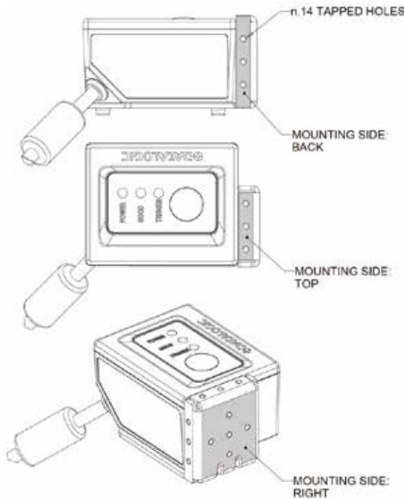
Вариант монтажа 2 для левого, фронтального и верхнего монтажа
