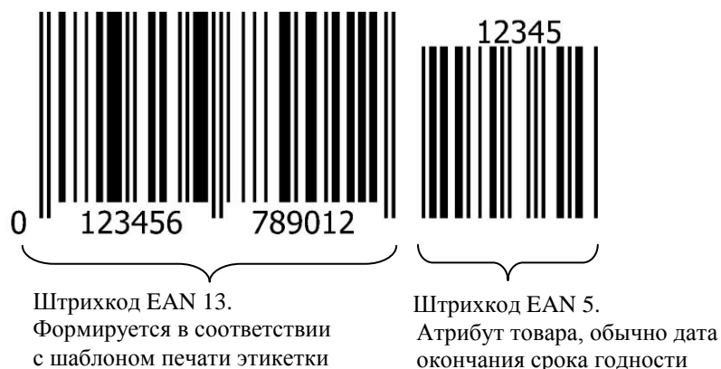
Рис. 6.2 – Структура штрихкода EAN 13+5
